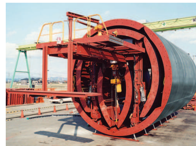
テレスコ内部 INSIDE TELESCOPIC STEEL FORM
