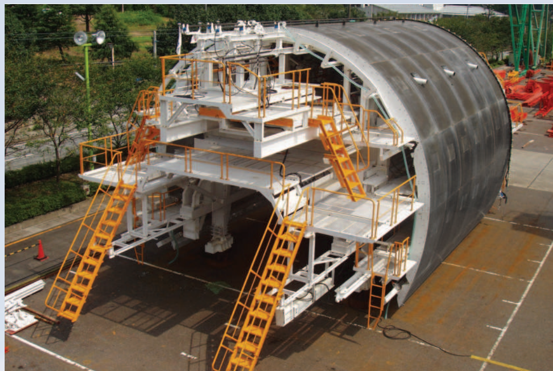
全断面スチールフォーム パイプ式引抜きパイブレーター＋エレファントノズルシステム搭載 ALL SECTION STEEL FORM EQUIPPED WITH PIPE-TYPE PULLING OUT VIBRATOR AND ELEPHANT NOZZLE SYSTEM
