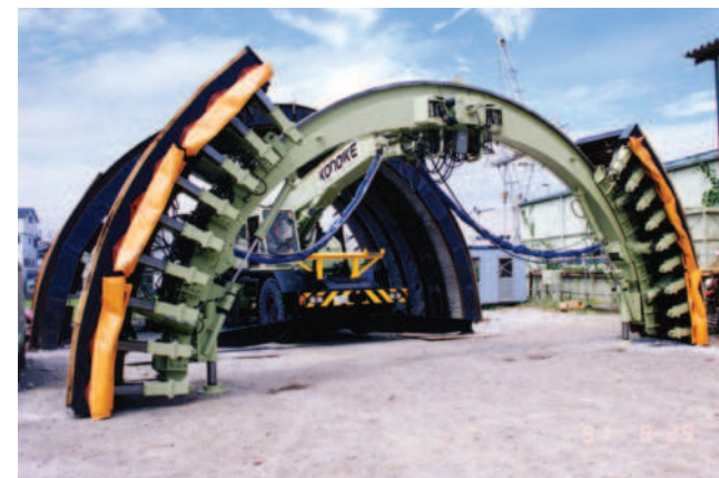
1次巻コンクリート覆工用圧着機【株式会社鴻池組・日立造船株式会社共同開発】（左右共：工場） PRE-CAST LINING MACHINE FOR THE PRIMARY COVERING WORK
