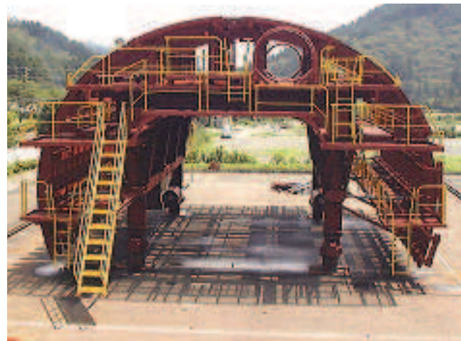
トラス仕様 TRUSS-TYPE
