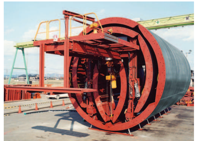
テレスコ内部 INSIDE TELESCOPIC STEEL FORM
