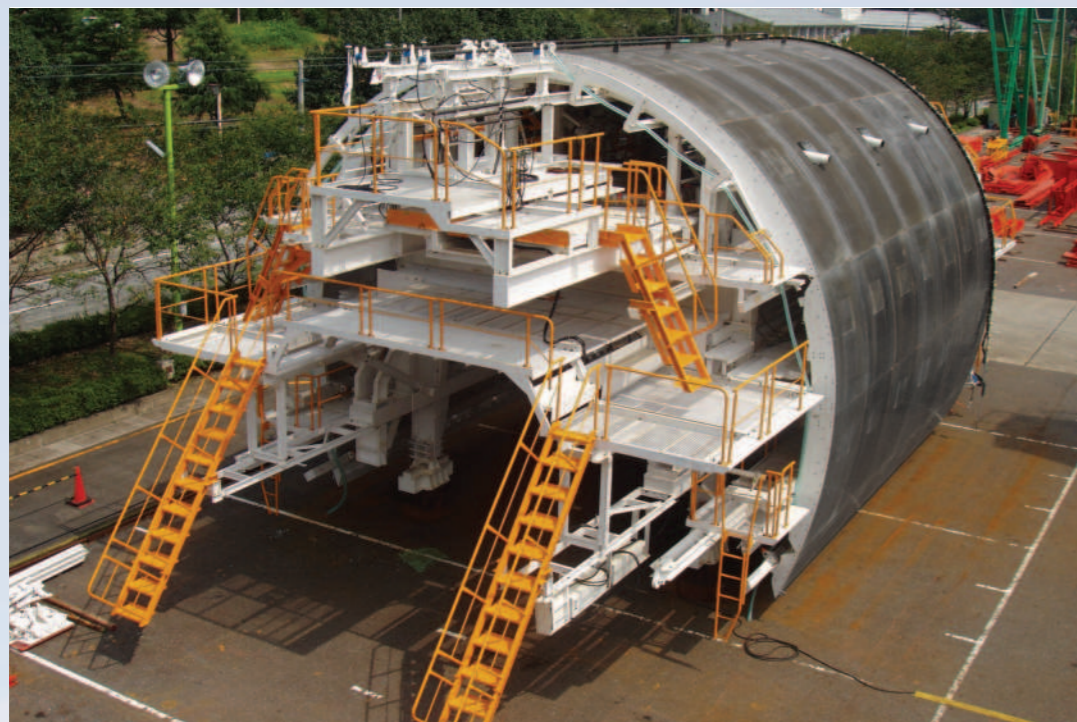
全断面スチールフォーム パイプ式引抜きバイブレーター＋エレファントノズルシステム搭載 ALL SECTION STEEL FORM EQUIPPED WITH PIPE-TYPE PULLING OUT VIBRATOR AND ELEPHANT NOZZLE SYSTEM
