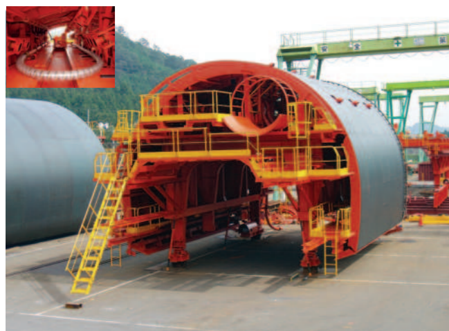
エレファントノズル(コンクリート配管システム) ELEPHANT NOZZLE (CONCRETE DISTRIBUTOR SYSTEM)
