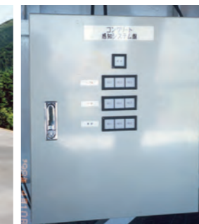
コンクリート充填感知センサー付検測ピン収納装置と制御盤 Storage Device and Control Box of Measuring Pin with Concrete Filling Sensor
