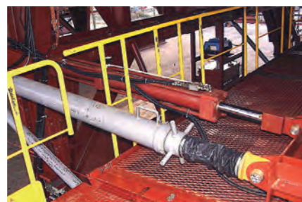
サイドフォーム用油圧シリンダー・ロック式特殊ジャッキ Side Form Oil Hydraulic Cylinder & Lock-Type Special Jack
