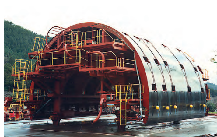
フロートバイブレータシステム搭載型全断面スチールフォーム All Section Steel Form Equipped with Float Vibrator System
