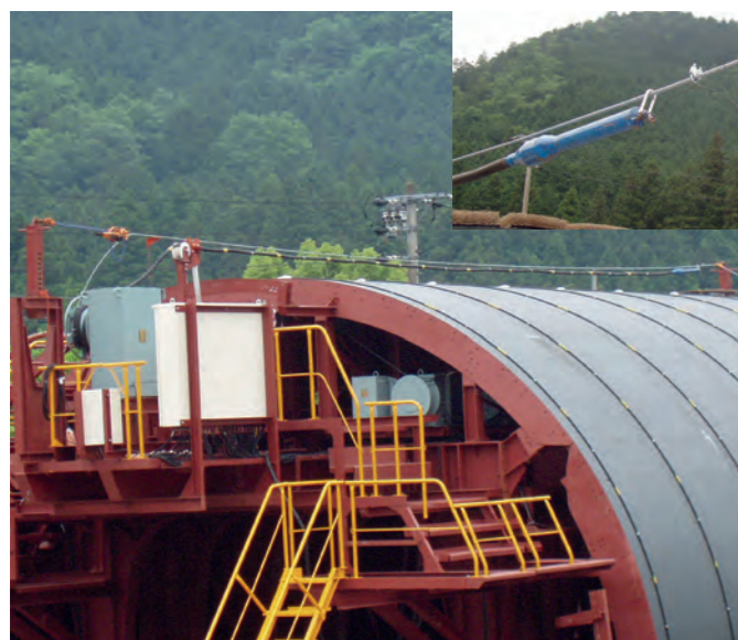
リール式引抜きバイブレータ (鉄筋無し) Reel Type (in case of there are no reinforcing bars)
