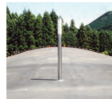
コンクリート充填感知センサー付検測ピン収納装置と制御盤 Storage Device and Control Box of Measuring Pin with Concrete Filling Sensor
